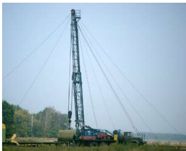
Med en mobil servicerigg kan Shelton Petroleum återuppta produktion ur gamla brunnar
